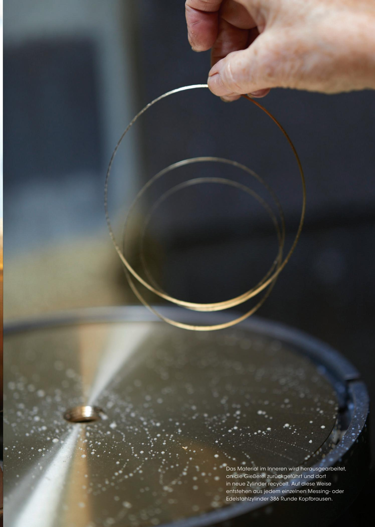
Das Material im Inneren wird herausgearbeitet, an die Gießerei zurückgeführt und dort in neue Zylinder recycelt. Auf diese Weise entstehen aus jedem einzelnen Messing- oder Edelstahlzylinder 386 Runde Kopfbrausen.
