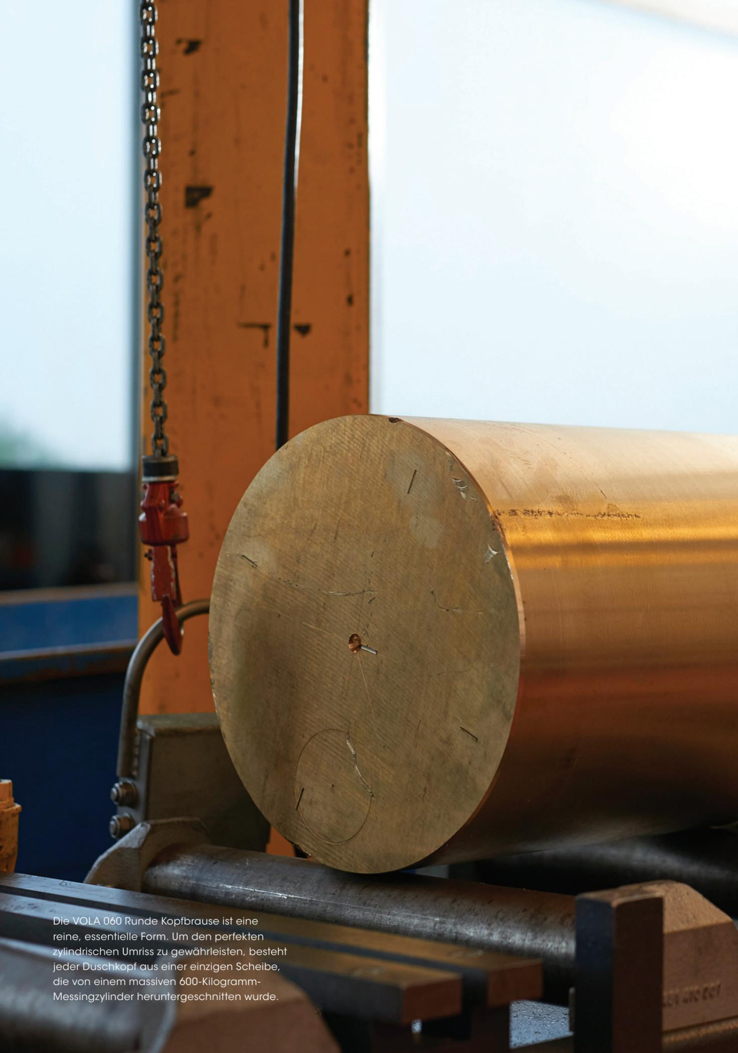
Die VOLA 060 Runde Kopfbrause ist eine reine, essentielle Form. Um den perfekten zylindrischen Umriss zu gewährleisten, besteht jeder Duschkopf aus einer einzigen Scheibe, die von einem massiven 600-Kilogramm-Messingzylinder heruntergeschnitten wurde.
